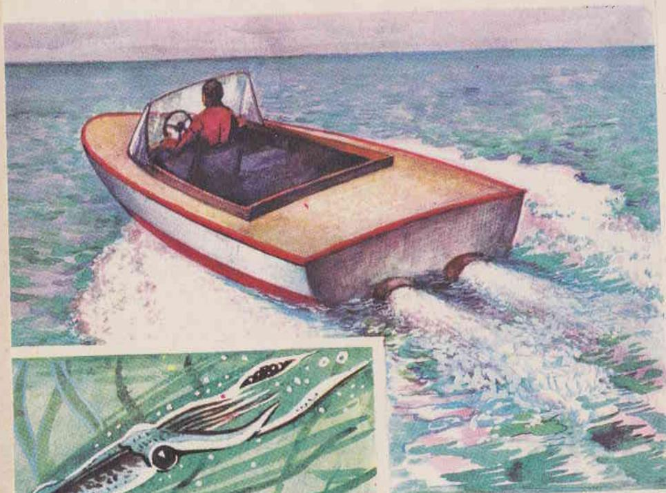
Рис. III. Водометный катер. На врезке: кальмар, использующий принцип реактивного движения.
